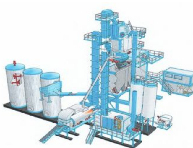
Rysunek. 1 Schemat instalacji do produkcji mas bitumicznych
