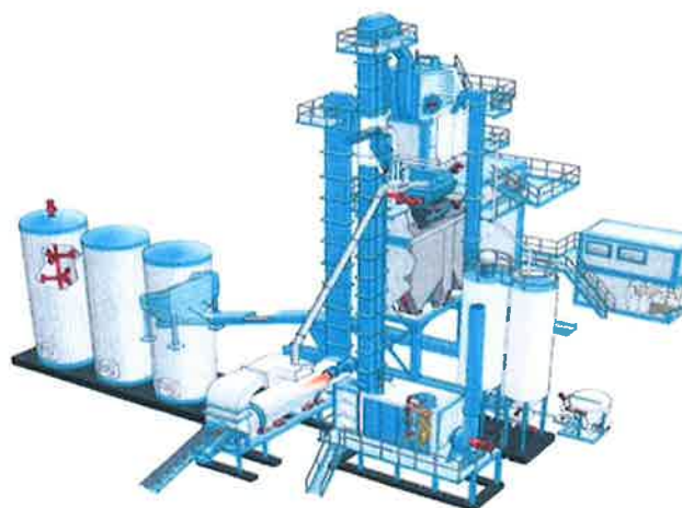
Rysunek 1. Schemat instalacji do produkcji mieszanki mineralno-asfaltowej
