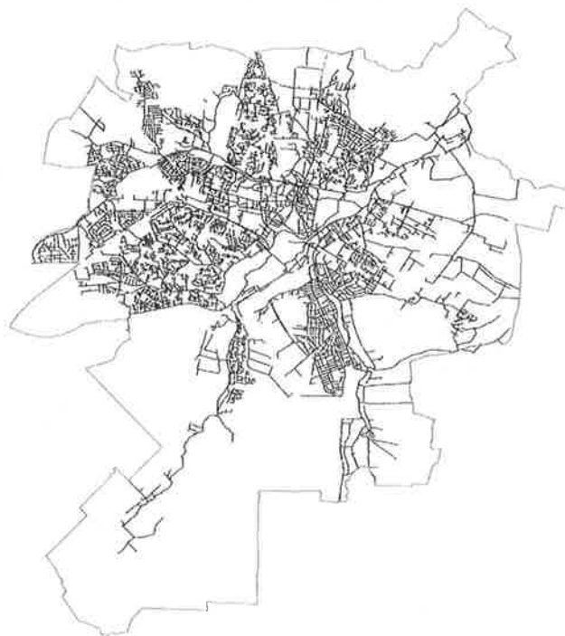
Schemat sieci kanalizacji sanitarnej miasta Lublin
